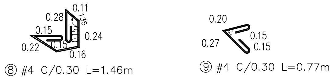
CORTE A – A DESPIECE SUMIDERO ESPECIAL 2.50m ESCALA 1:20
